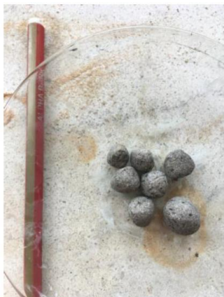
Εικόνα 4.3.1. Δοκιμαστικά σφαιρικά συσσωματώματα (pellets) από ομογενοποιημένη ποσότητα ιπτάμενης τέφρας (VP_FA_COMP) (αριστερή φωτογραφία) και εργαστηριακή παραγωγή pellets (δεξιά φωτογραφία).
